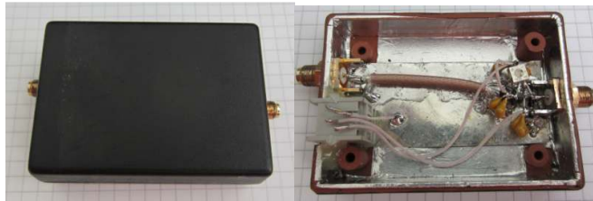
3.2. att. Antenu ierosmes impulsu ģeneratora modulis ar koaksiālu izeju
