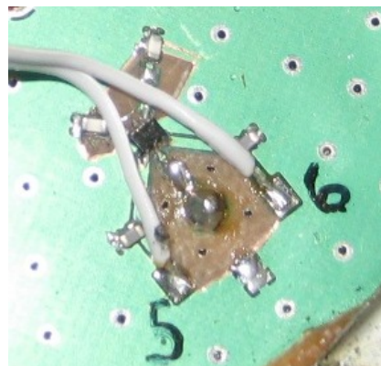
Att. 5.3: Antenas montāžas plates fragments: pasīvā elementa elektroniskais slēdzis. Montāžas parazitiskās kapacitātes novēršana.
