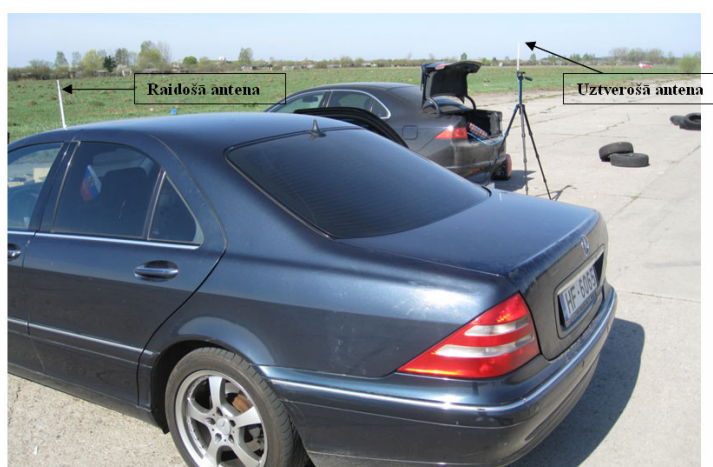
4.6. att. Uztverošā un raidošā antenas izvietojums
