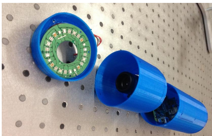
Att.3.4. Iekārtas prototipa izdrukā, izmantojot izveidoto 3D modeli.
