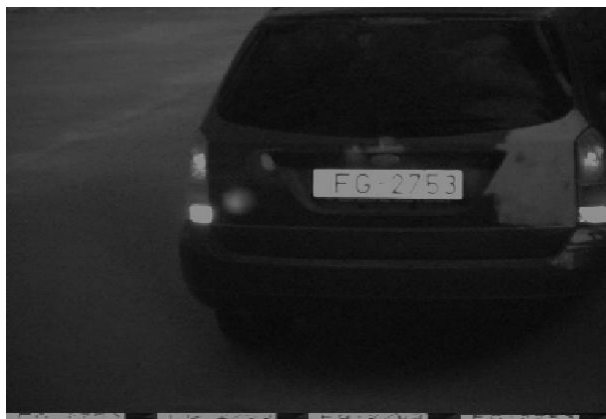
Att. 3.3: Automobiļa attēls, izmantojot IR prožektoru
