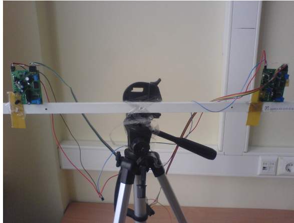
Att. 1.1: Magnētiskā sensora prototips
