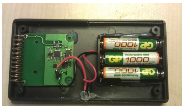
Att. 2.3: Ciparu magnētiskais sensors ar ietvaru un barošanas elementu
