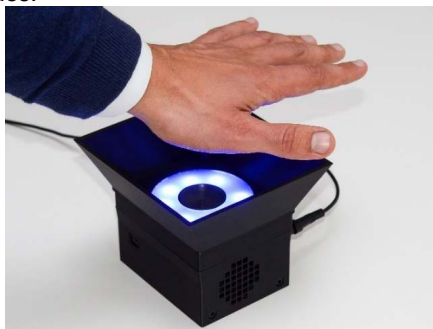
Att. 12 – veidojamā biometriskā sistēma. Attēlā redzama iekārtas korpuss ar blendi aizsardzībai no apkārtējā apgaismojuma. Iekārtai tiek prezentēta plauksta.
