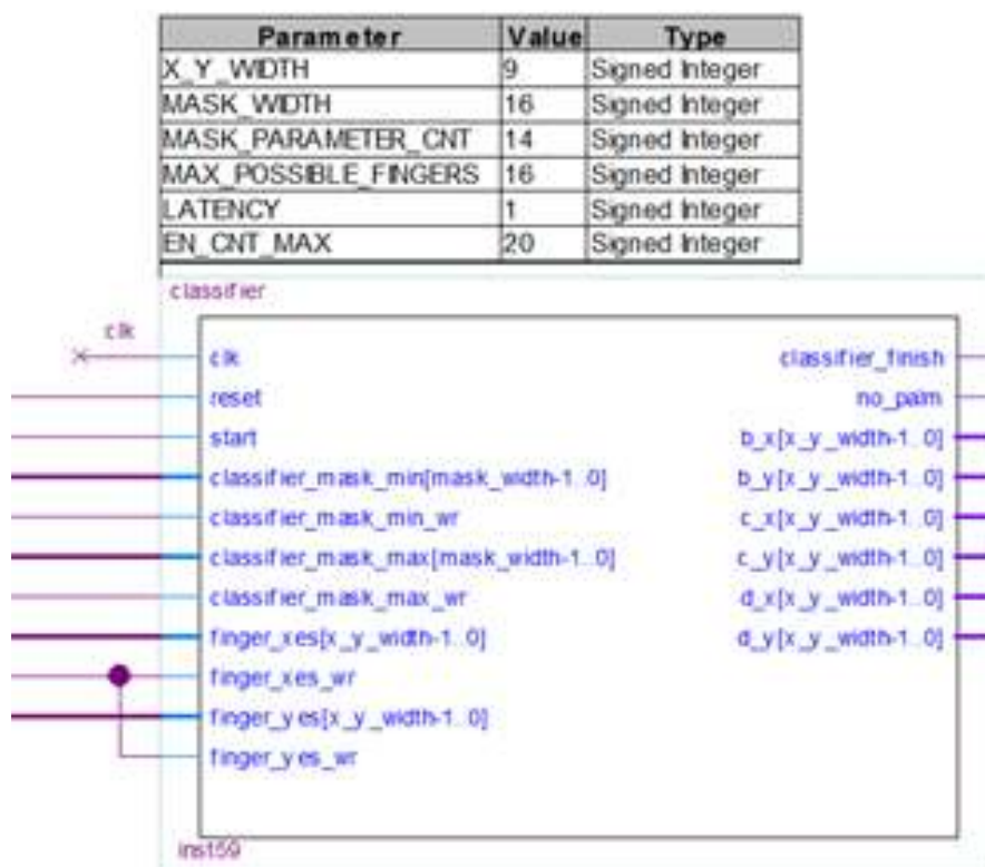
Att. 12. Pirkstu starpu klasifikatora bloks Quartus vidē
