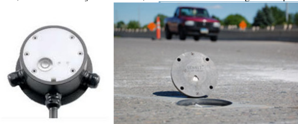
3.2. Attēls. Invazīvā brauktuves stāvokļa sensora iestrāde ceļā
