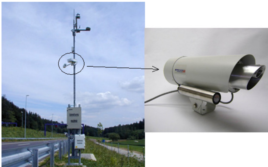
3.1 Attēls. Neinvazīvs ceļa stāvokļa un meteo stacijas punkts
