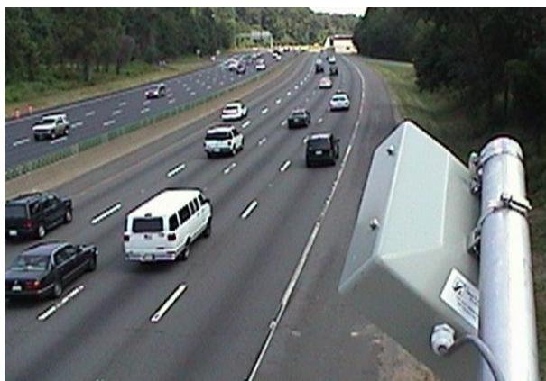
1.5. attēls. Akustiskā sensora novietojums
