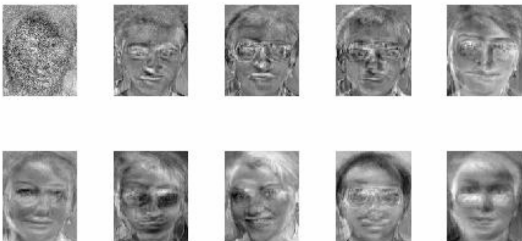
4.3.4. zīm. Datu bāzei izrēķinātas „Eigenfaces” ar lielākajām īpašvērtībām
