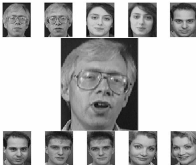
4.3.5. zīm. Jaunās fotogrāfijas (pirmais cilvēks no datu bāzes) identifikācija pēc „Eigenface” algoritma
