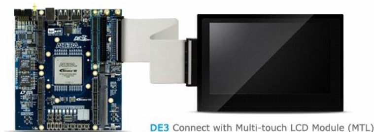
13.attēls. Terasic MTL skārienjūtīgais LCD modulis
