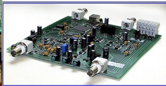
Ekstrēmas precizitātes notikumu taimeri satelītu lāzerlokācijai (2000-tajos)
